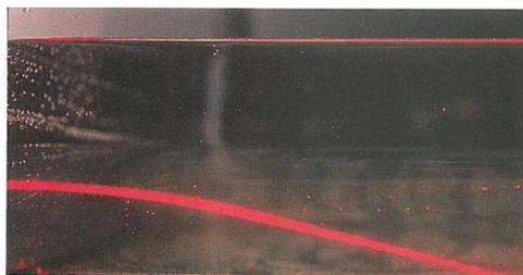
Sur la photographie ci-contre, on visualise un faisceau de lumière issu d'une source laser. La lumière traverse la cuve qui contient une solution saturée en sucre dans le fond.
